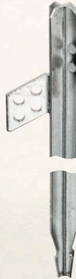
Dispersore a croce con bandella obliqua a 4 fori  $\varnothing$ 13 mm e punta brevettata, Profilato omogeneo in acciaio zincato a fuoco, 50x50x5mm. Materiale FE 360 B.
